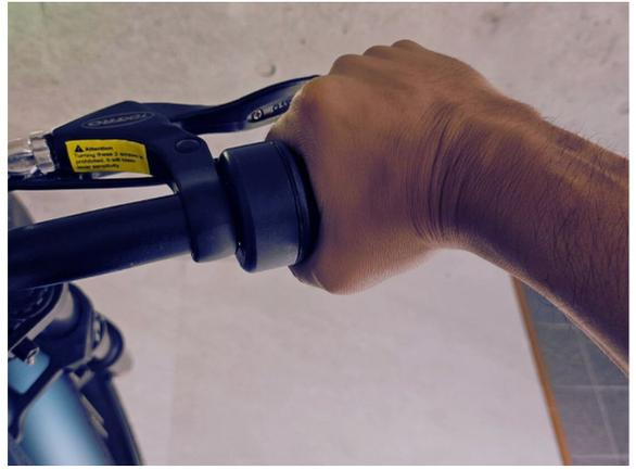
⑬アクセルスロットルを手前に回すとモーターが回り、車体が前進します。
