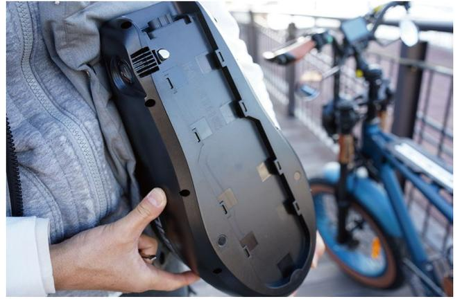
② バッテリーの溝とマウントの溝が合うようになっています。
