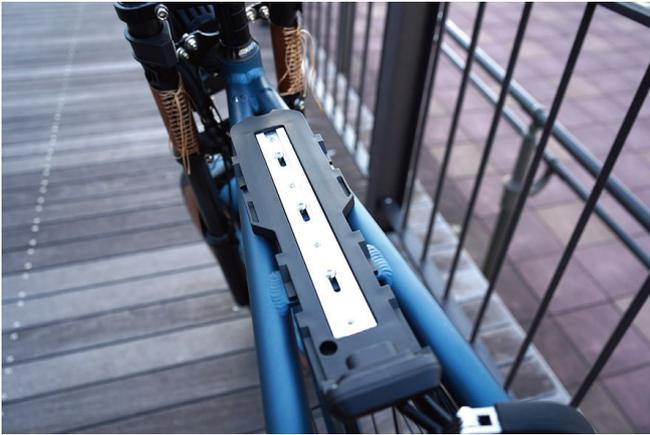
① 取外しと逆の手順でバッテリーマウントへバッテリーを乗せます。
