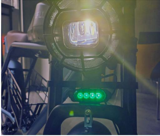
⑦電源を入れると、ヘッドライトと最高速度表示灯が自動で点灯します。
