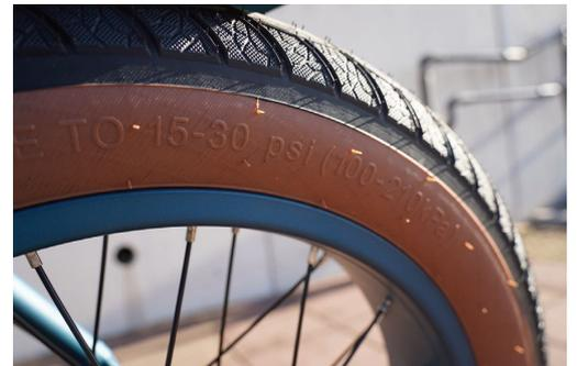
※タイヤサイズが同じでもメーカーやタイプによって適正空気圧が異なりますので必ずタイヤの記載をご確認下さい。
