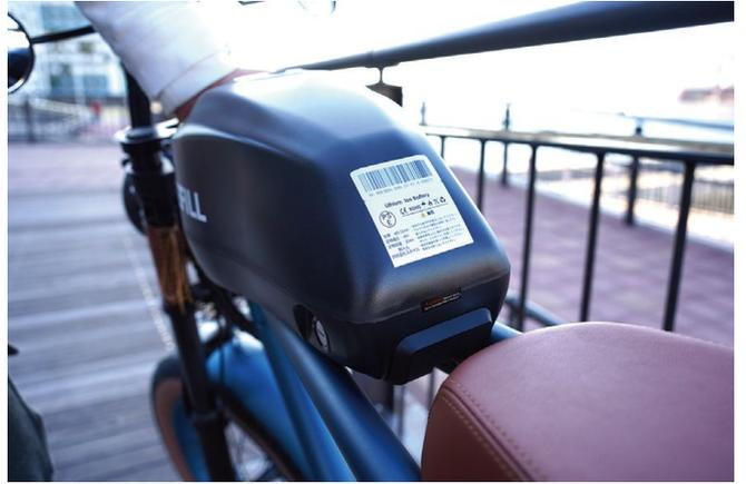
④ 両手でしっかりと持ち、バッテリーを後方部へ少し強めにスライドさせ、カチッと音が鳴ればロック完了です。
